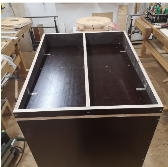
Unterkonstruktion mit den Blenden
